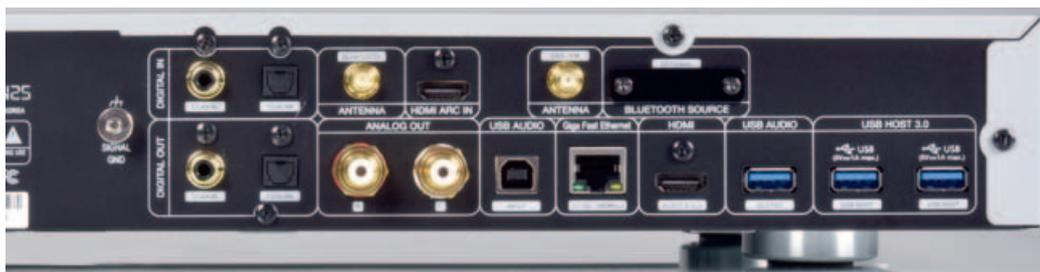
Der N25 verfügt über Digitaleingänge per SPDIF, USB und HDMI. Das Gleiche gilt für die Ausgänge, hinzu kommen ein HDMI-Rückkanal sowie Analog-Line-Anschlüsse. Dafür ist wahlweise der Pegel einstellbar, sodass das Gerät auch als Vorverstärker dienen kann. Ausgegeben werden per HDMI nur Stereo-Signale.
