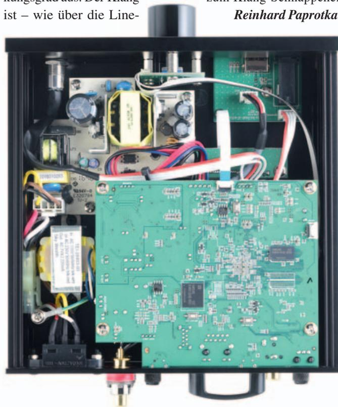
Das wertige, aus Alu gefertigte Gehäuse des N15 offenbart bei abgenommenem Deckel eine komplexe Multilayer-Platine. Der klangstarke Sabre-D/A-Wandler ist nicht sichtbar von unten montiert.
