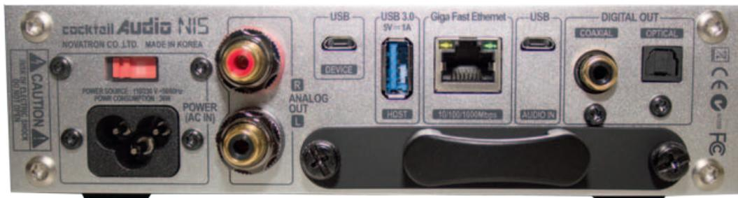
Der N15 enthält Analogausgänge, dazu S/PDIF, koaxial und Toslink. Die USB-3.0-Buchse dient dem Anschluss externer Speicher oder der mitgelieferten WLAN-Antenne. Darüber hinaus gibt es Micro-USB für Smartphone und Audio-Input. Einbauen lassen sich eine SSD oder 2,5-Zoll-HDD bis 7 mm Bauhöhe.
