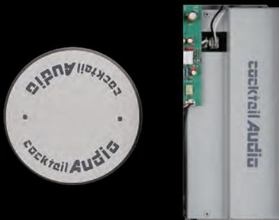
Um elektrische Geräusche und Geräusche im Ruhezustand zu minimieren, wurde der Leistungskreis für digitale und analoge Teile isoliert angelegt, der Ringkerntransformator und das Schaltnetzteil sind optimal durch Aluminium geschützt.
