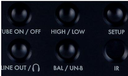
Die 5 Funktionstasten: An-/Aus der Röhren, Einstellen der Kopfhörereimpedanz (High/Low), Setup-Menü, Line Out-Ausgang oder Kopfhörerausgang, Symmetrisch oder Unsymmetrisch für Kopfhörerausgang
