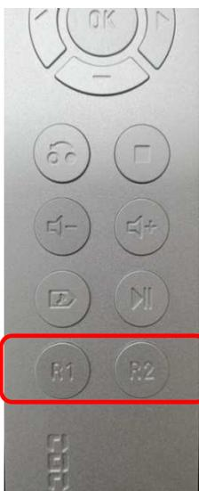
Bei der über den Zubehör erhältlichen Aluminiumfernbedienung, können nun die 2 zusätzlichen Funktionstasten mit einer Funktion belegt werden
