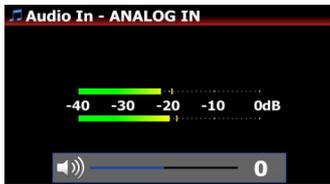
② Regeln Sie den Lautstärkepegel mit dem Drehknopf für die Lautstärke, der VOL- oder der LINKS/RECHTS-Taste.
