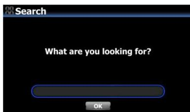
Im Internetradio-Menü drücken Sie auf die SEARCH-Taste der Fernbedienung. Das Suche-Fenster wird geöffnet. Geben Sie die ersten Buchstaben des Senders ein, wählen Sie OK und bestätigen Sie mit der OK-Taste. Die Suchergebnisse (auch Sender mit ähnlichen Namen) werden aufgelistet.
