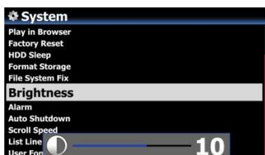
Im SETUP-Menü unter System wählen Sie den Menüpunkt Helligkeit. Mit den LINKS/RECHTS-Pfeiltasten der Fernbedienung können Sie die gewünschte Helligkeit einstellen.
