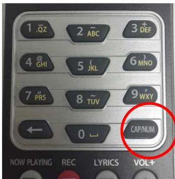
Durch Drücken der CAP/NUM-Taste auf der Fernbedienung können Sie zwischen den beiden Modi 'Springe zu Prozent' und 'Springe zu Song' umschalten.
