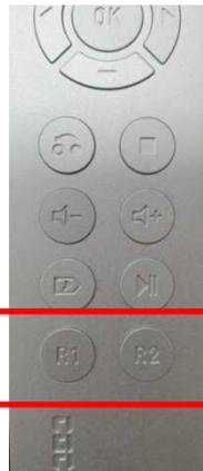
Öffnen Sie das SETUP-Menü > System > „R1 (bzw. R2) key of 2nd RC“ und wählen Sie aus sämtlichen Fernbedienungsfunktionen die gewünschte Tastenbelegung aus.
