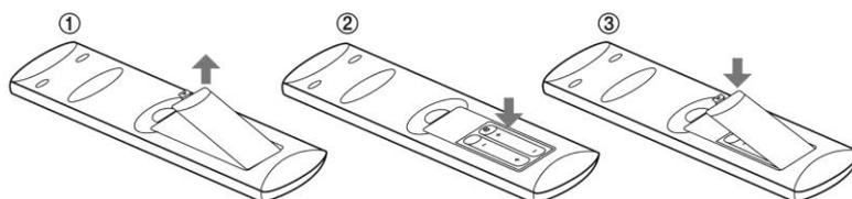
Öffnen Sie das Batteriefach und legen Sie die beiden AAA-Batterien ein.
