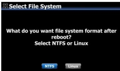
⑤ Wenn Sie mit OK bestätigen, werden Sie vom X50D zur Auswahl des Dateisystems aufgefordert (NTFS oder Linux).
