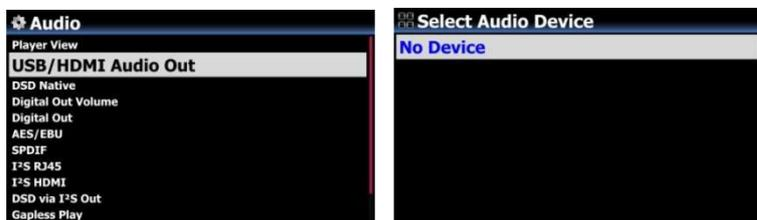
Wenn ein USB DAC oder ein HDMI-Audiogerät an den Audioausgang des X35 angeschlossen ist, werden die angeschlossenen Geräte hier angezeigt und können ausgewählt werden.
