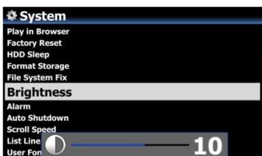
Im SETUP-Menü unter System wählen Sie den Menüpunkt Helligkeit. Mit den LINKS/RECHTS-Pfeiltasten der Fernbedienung können Sie die gewünschte Helligkeit einstellen.
