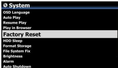
Um die vorgenommenen Einstellungen auf Werkseinstellungen zurückzusetzen, öffnen Sie das SETUP-Menü -> System -> Werkseinstellungen und bestätigen mit OK.
