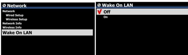
Wenn bei "Wake ON LAN" AN eingestellt ist, kann der X35 durch ein Signal von außen via Netzwerk eingeschaltet werden.
