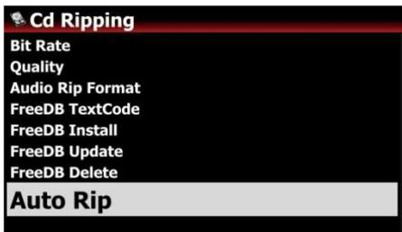
Wenn Sie viele CDs rippen möchten, ist diese Funktion hilfreich. Ist die Auto-Rip-Funktion aktiviert (AN), führt der X35 beim Einlegen einer CD den Rip-Vorgang automatisch durch und wirft danach die CD von selbst wieder aus, ohne dass Sie irgendeine Taste drücken müssen.
